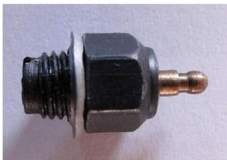
*Fig. 20 - Si tratta di una candela Faro che consente di apprezzare la profondità dell'incisione su cui si inseriva l'estremità della spiralina di platino iridio. Nella foto si intravede la grossa sezione del filo sul colletto (4/10 mm).*
