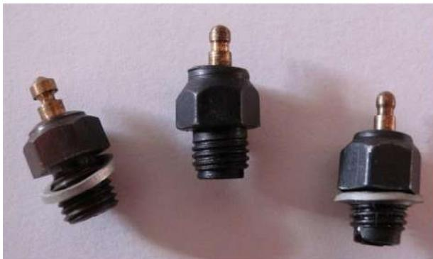
*Fig. 15 - La foto mostra al centro uno dei prototipi che dovrebbe risalire alla fine del 1948 e mostra l'elettrodo centrale di ottone ed il corpo tornito col colletto superiore che veniva ribordato a fissare il tutto. A destra si colloca una tipica candela Faro la cui manifattura è già più curata ed è attribuibile al 1949. La candela a sinistra appare essere una Candela Faranda dell'ultima produzione che va collocata entro l'autunno del 1950.*
