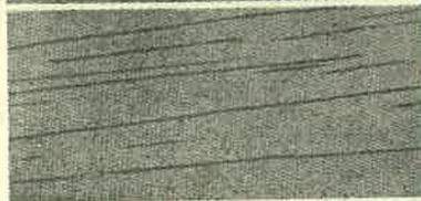
**Balsa duro:** di colore bruno chiaro con striature caratteristiche (fig. 6 a), adatto per longheroni di modelli di medie dimensioni, e per listelli di forza di fusoliere.
