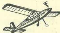
**SQUIRREL.** — Modello ad elastico per principianti. Apertura alare cm. 72. Superficie dmq. 7,56. Lunghezza cm. 560. Ala a forma trapezoidale. Fusoliera a cassetta in balsa. Ottime doti di volo. Nella scatola tutti i pezzi sono fustellati, prefabbricati o finiti.
